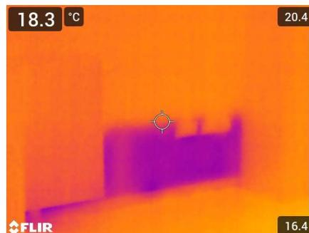
FIGURE 36 : OPERATION B - CLICHE THERMOGRAPHIQUE D'UNE PAROI DEPERDITIVE DONNANT SUR L'EXTERIEUR ; APPARTEMENT 101, CHAMBRE DU FOND
