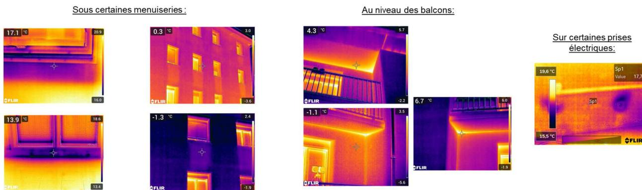
FIGURE 20 : CLICHES THERMOGRAPHIQUES INTERIEURS ET EXTERIEURS (OPERATION A)
