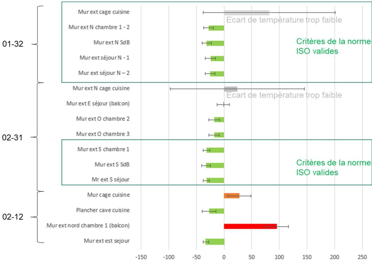
FIGURE 31 : ECARTS MESURE-CALCUL DES MESURES LOCALES DE TRANSMISSION THERMIQUE (OPERATION A)
