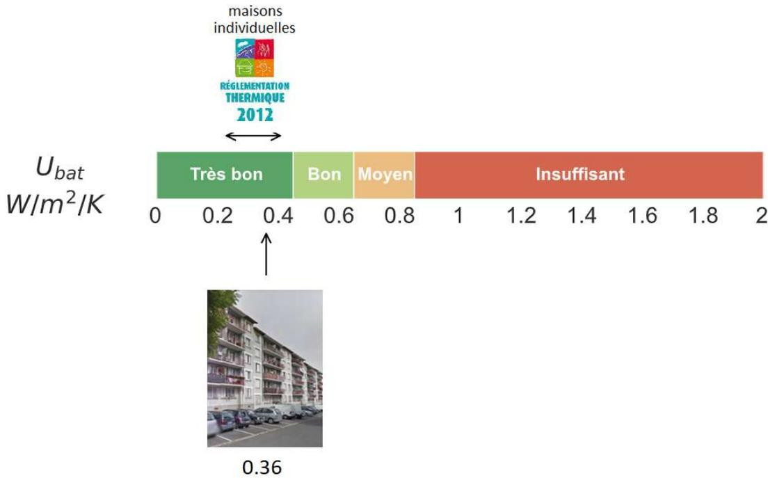
FIGURE 68 : POSITIONNEMENT DU NIVEAU D'ISOLATION POUR LE CAS D'ETUDE NUMERIQUES « HAUTE PERFORMANCE »
