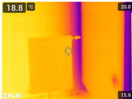
FIGURE 39 : OPERATION B - CLICHE THERMOGRAPHIQUE D'UN PONT THERMIQUE D'ANGLE ; APPARTEMENT 101
